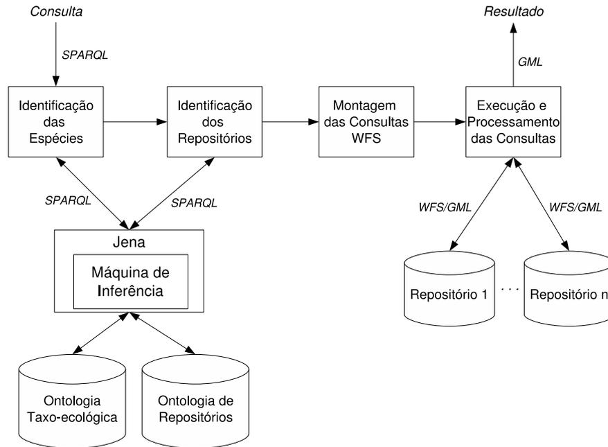
Figura 4.4: Fases do processamento de consultas no protótipo
