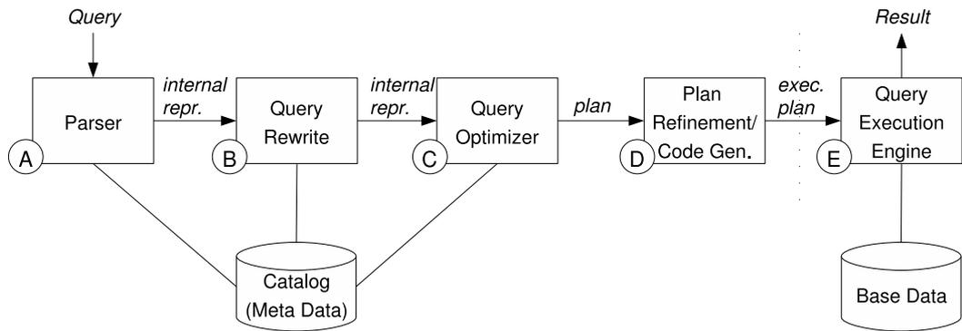
Figura 2.12: Fases do processamento de consultas (retirada de [50])
