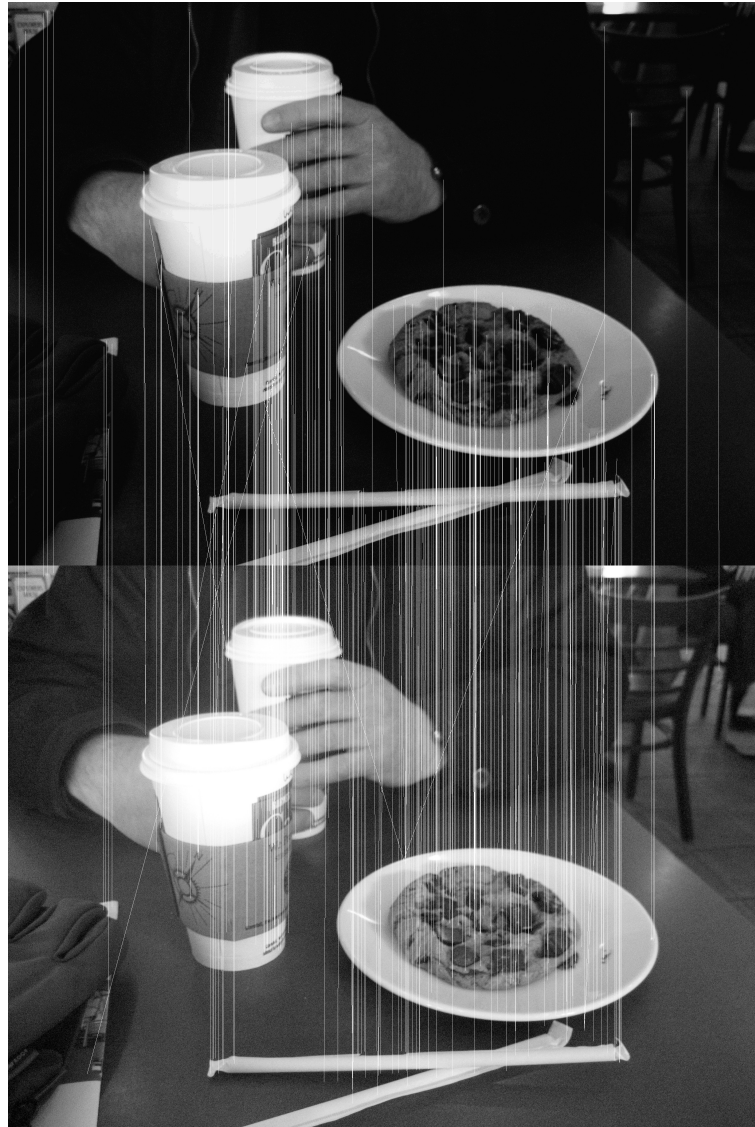
Figura 4.10: Pontos encontrados pelo SURF e seus casamentos em duas imagens idênticas, exceto pelas condições de iluminação, artificialmente modificadas.
