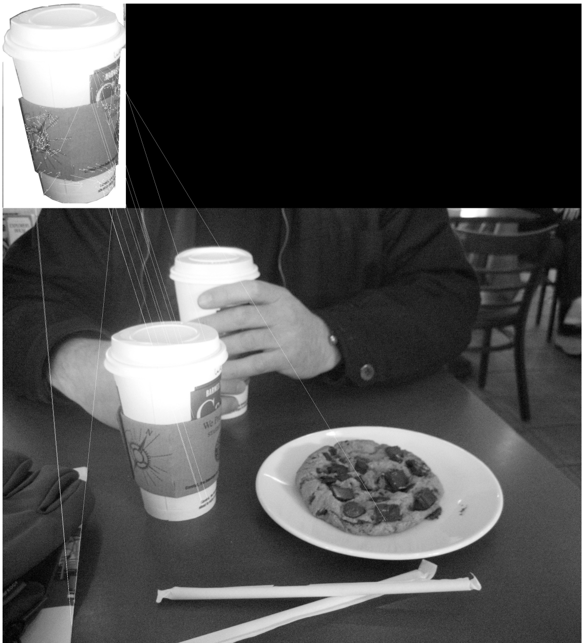
Figura 4.8: Pontos encontrados pelo SURF em uma imagem contendo apenas um objeto e seus casamentos em uma imagem contendo uma cena complexa da qual faz parte o objeto original. O objeto encontra-se na mesma pose em ambas as imagens.
