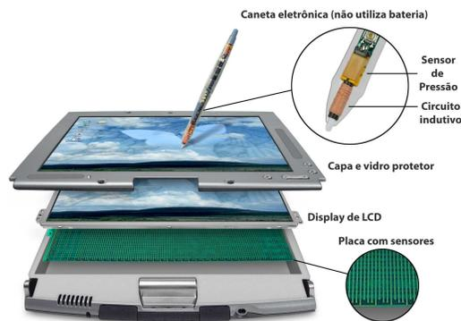
Figura 2.3: Esquemático do hardware de escrita baseado em *digitizer* magnético
