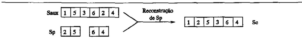
Figura 5.11: Exemplo da reconstrução de uma solução parcial  $s_p$  usando uma solução completa auxiliar  $s_{aux}$ .
