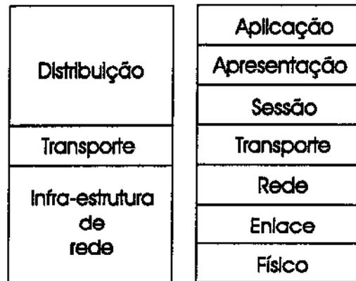
Figura 2.4: Níveis de QoS e o modelo OSI
