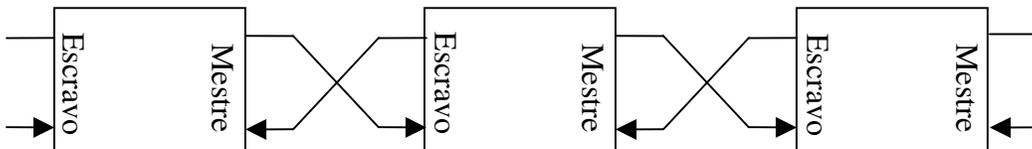
Figura 21 – Interconexão de fluxo de dados no Wishbone
