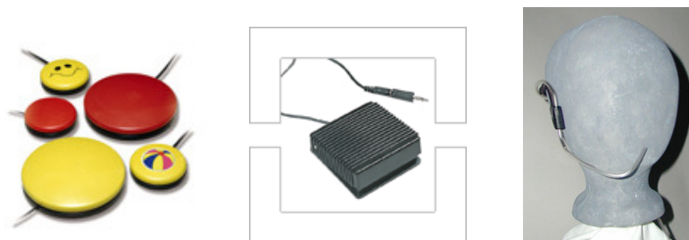
Figura 3. 1. Exemplos de acionadores para uso com teclados virtuais. À esquerda, botões circulares de diferentes tamanhos. Ao centro, um pedal. À direita, acionador baseado em sopro e sucção.
