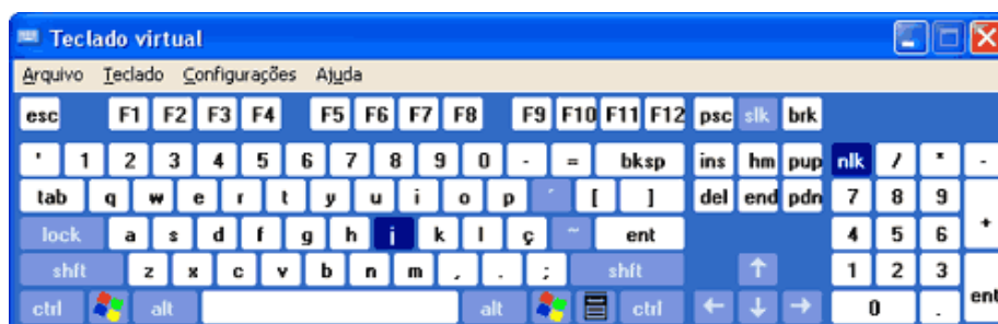
Figura 3. 2. Teclado Virtual do Windows XP. No caso, a varredura linear está passando exatamente pela letra “j” (em destaque).
