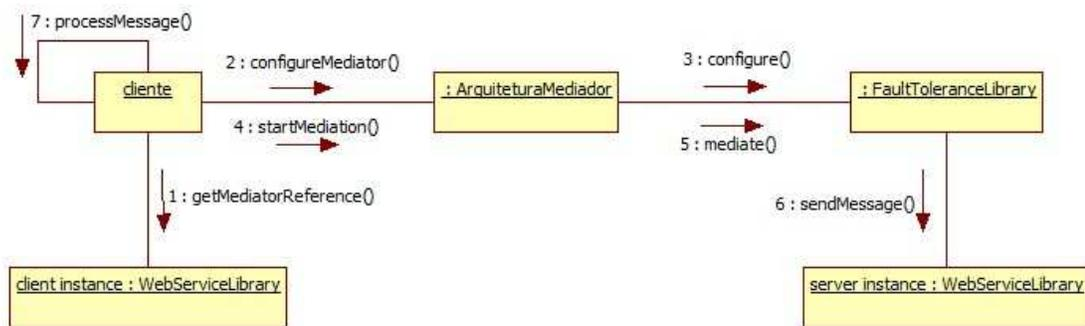
Figura 3.2: Diagrama de colaboração UML com as interações entre os componentes da Arquitetura Mediator.
