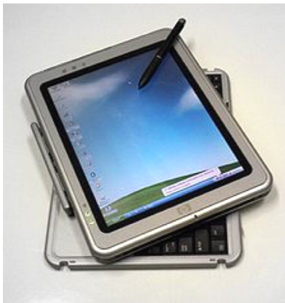
Figura 3.1. Exemplo de Tablet PC e sua caneta eletrônica
