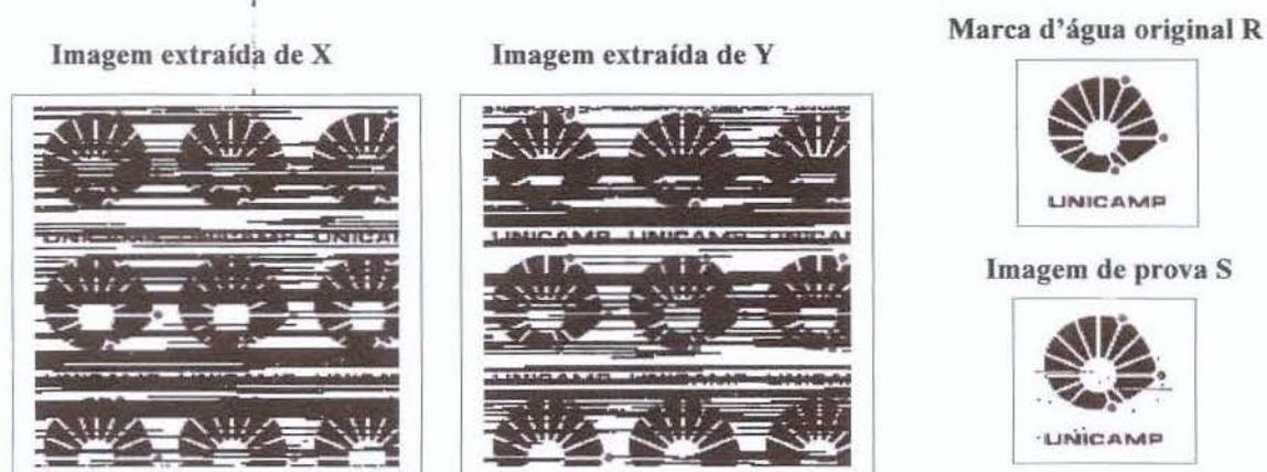
Figura 4.18 – Comparação entre a imagem final extraída e a marca d'água inserida ( $r = 0.99$ ,  $h = 5$ )
