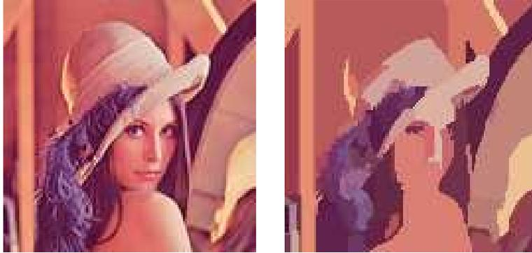
Figura 2.10: Exemplo de uma imagem segmentada com o algoritmo CBC.
