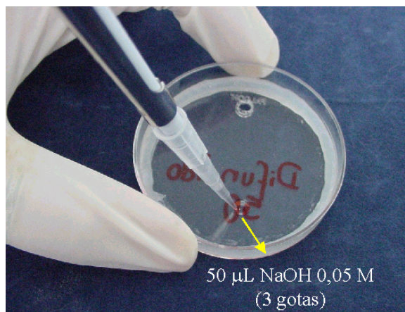
Figura 4 – Colocação das 3 gotas de NaOH.
