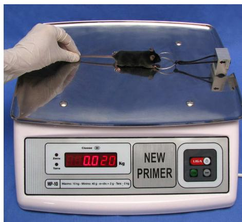
**Figura 3:** *Grip Strength Meter* para medir a força de tração exercida pelos membros anteriores do camundongo.
