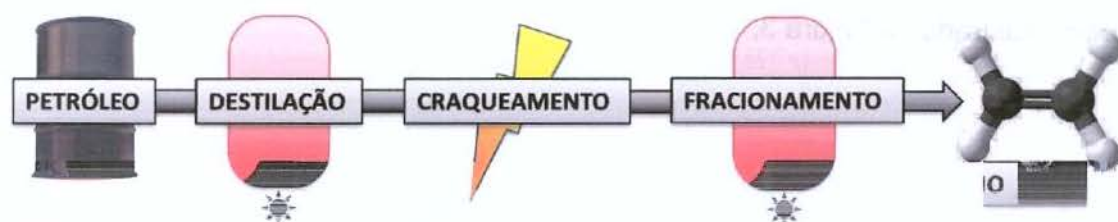
Figura 1: Etapas de produção convencional de eteno a partir de petróleo fóssil. Todas as operações unitárias a partir da extração do petróleo até a obtenção do eteno demandam uma alta quantidade de energia (WADE, 2009).
