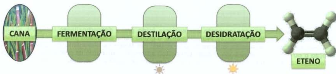
Figura 2: Etapas de produção de "eteno verde", como a realizada pela empresa Braskem (BRASKEM, 2011). Condições de processo amenas contribuem para a sustentabilidade do eteno verde.
