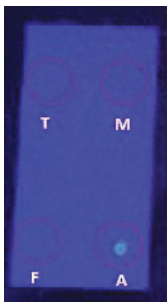
Figura 22: Foto de placa cromatográfica revelada em luz UV no comprimento de onda de 365 nm. A amostra de ativo livre eluído com metanol; F amostra de formulação lipossomal eluído com tampão fosfato; M metanol e T tampão fosfato.
