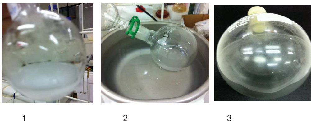
Figura 18: Fotografias relativas às 3 etapas do procedimento ML_D obtendo um filme homogêneo. 1 etapa da solubilização da Fosfatidilcolina e Colesterol em Metanol. 2 etapa da evaporação do Clorofórmio e 3 obtenção do filme lipídico seco delgado.
