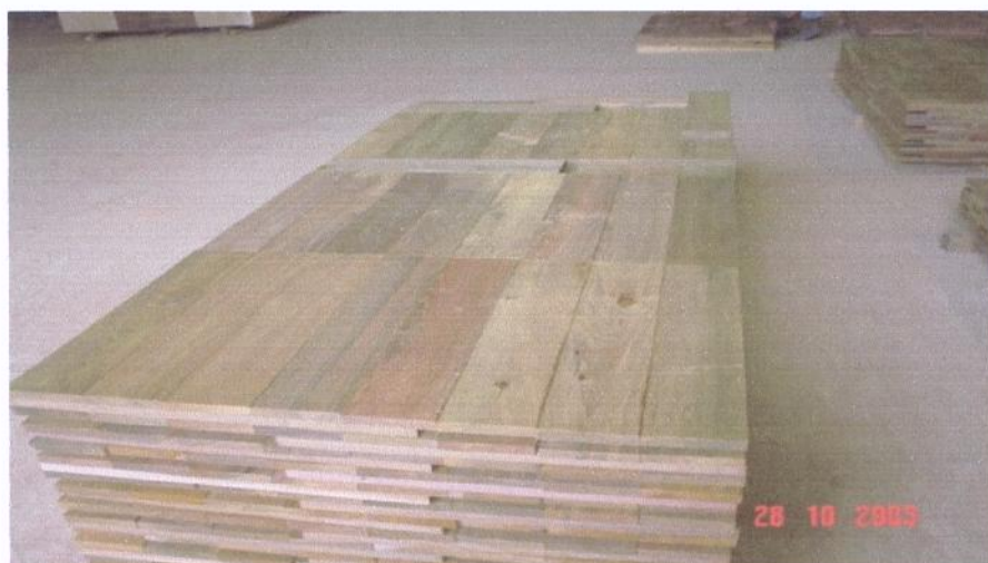
Figura 2. Coloração verde intensa de peças de Ipê ( Tabebuia sp), após processamento mecânico, no pátio da indústria.
