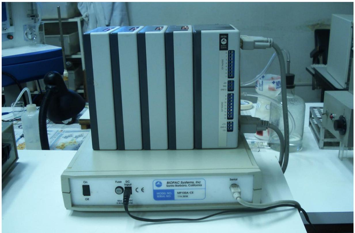
Figura 11 - Sistema BIOPAC MP 100A para registro da pressão arterial.
