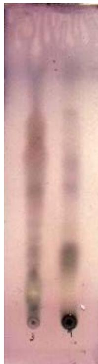
**Figura 8.** Cromatografia de Camada Delgada (CCD) dos extratos brutos diclorometânicos da folhas secas (1) e folhas frescas (2). Fase móvel (F.M.): Butanol/ Ac. Acético/ diclorometano/ metanol 99:1 e revelador: água destilada 4:1:5 e revelador: anisaldeído.
