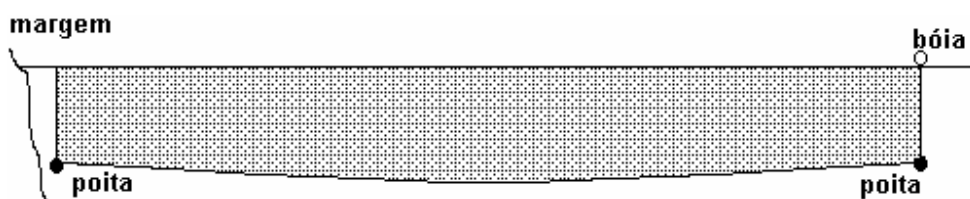
Figura 5: Esquema de disposição da rede a partir da margem
