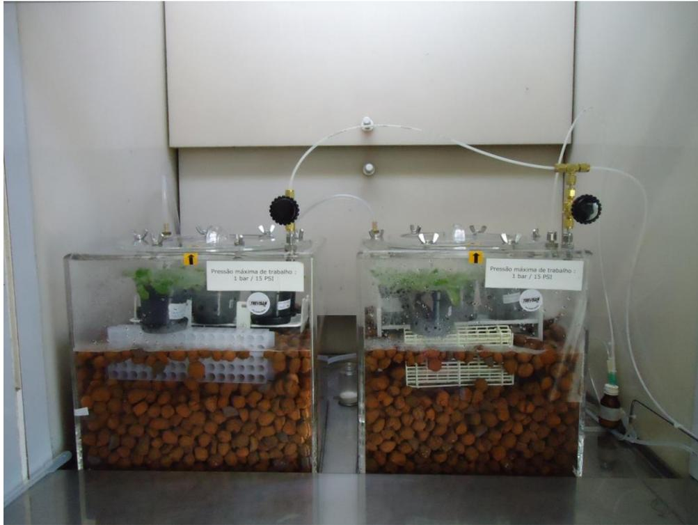
FIGURA 2: Câmara de fumigação construída no laboratório para o tratamento das plantas com o gás NO.
