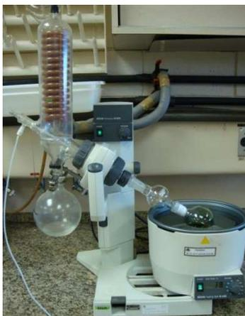
**Figura 4.** Foto ilustrativa do Rotaevaporador marca Büchi, modelo R 200.
