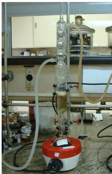
**Figura 7.** Foto ilustrativa do sistema para extração por sistema *Soxhlet*.
