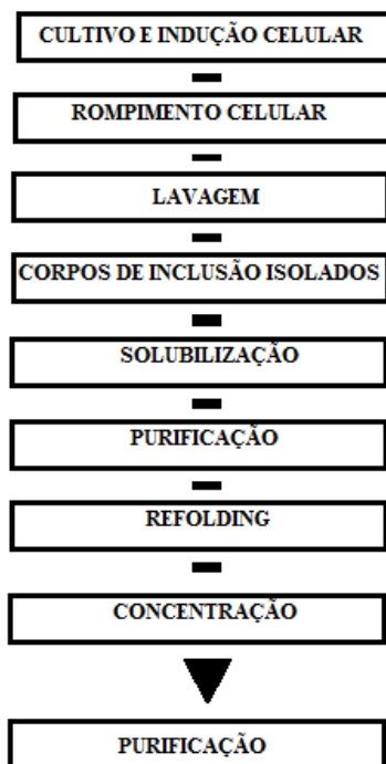
Figura 12. Fluxograma do processo empregado para obtenção de feruloil esterase bioativa a partir de corpos de inclusão.
