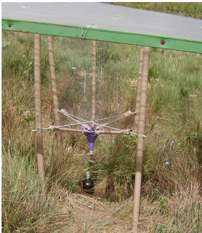
**Figura 2.** Estrutura coletora de água da neblina montada no interior do Parque Estadual de Campos do Jordão-SP. Esse coletor foi construído baseado no desenho proposto por Fisher e Still (2007).
