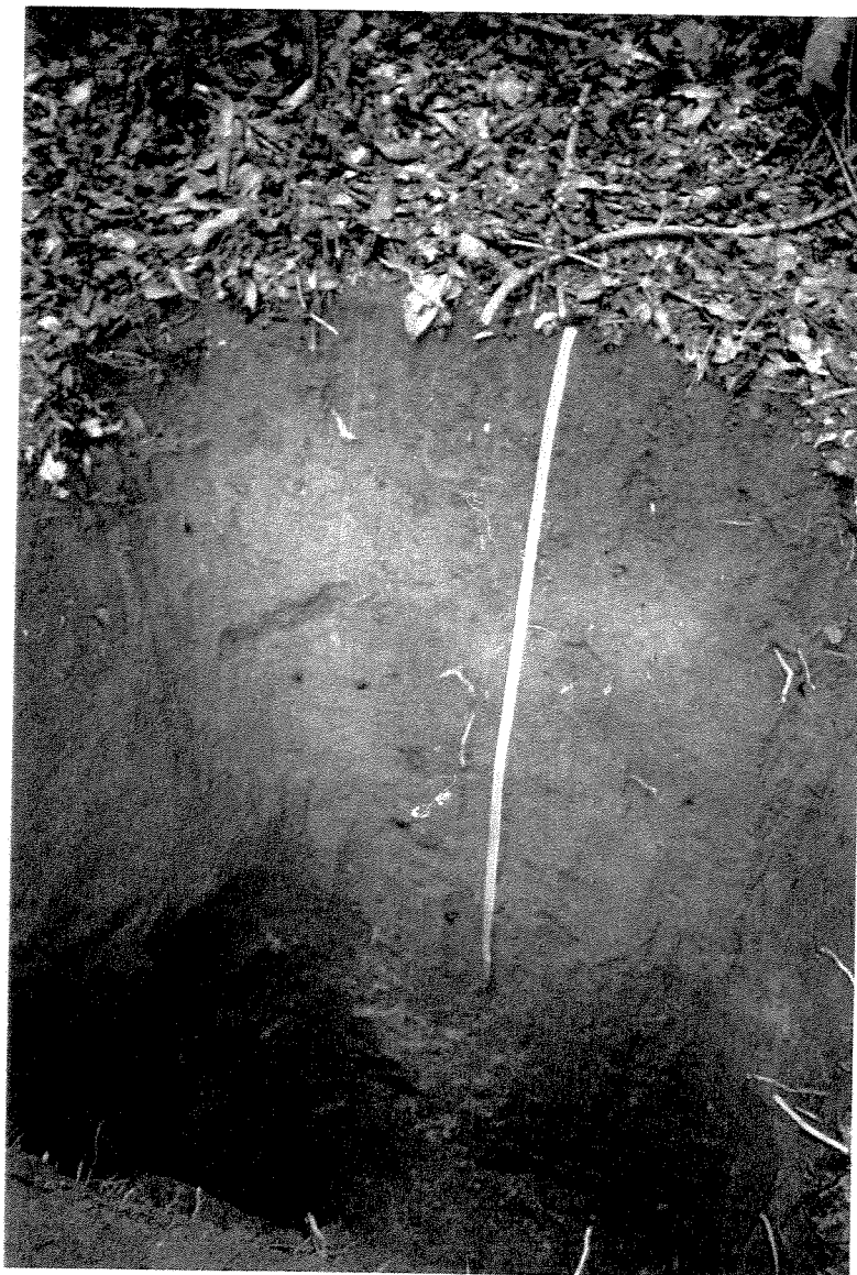
Apêndice 10. Neossolo câmbico melânico A proeminente Tb distrófico textura argilosa (perfil 9), Núcleo Águas Claras, Parque Estadual da Cantareira, Mairiporã-SP.
