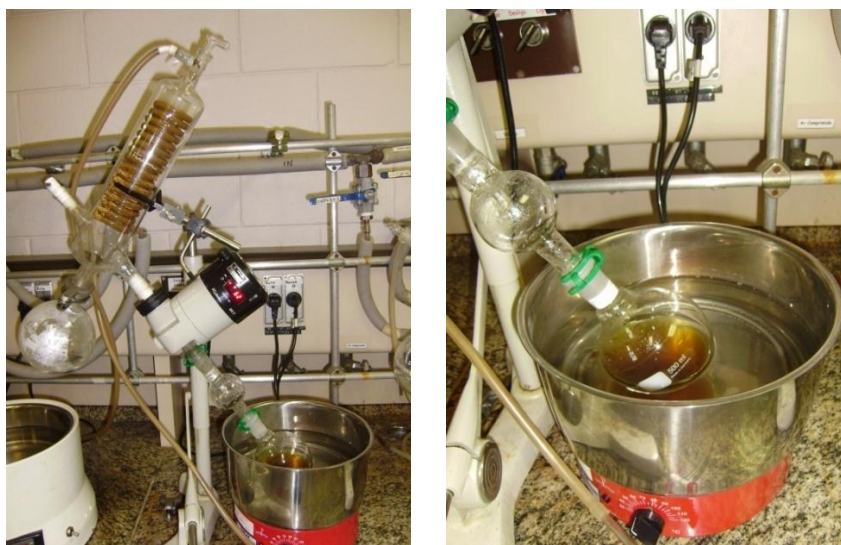
Figura 7: Sistema de evaporação a vácuo utilizado na secagem dos extratos e frações de B. trimera .
