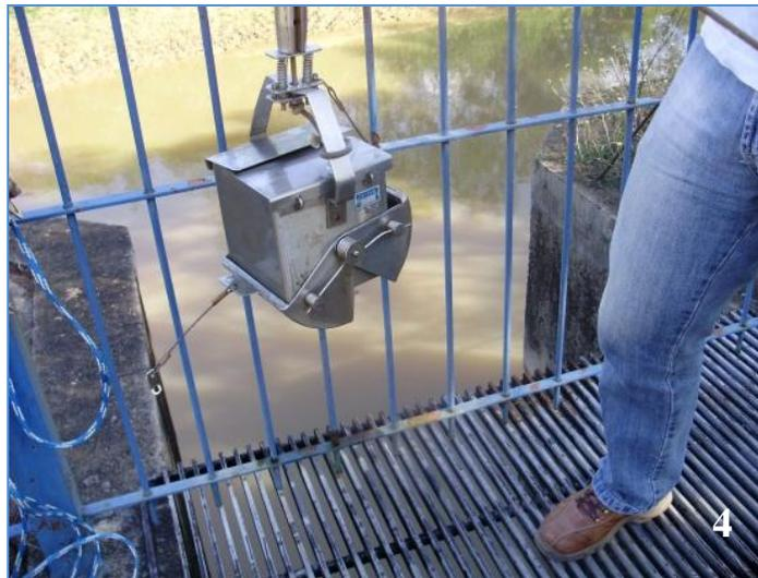
**Figura 4: Draga de Ekman modelo B5023 utilizada para as coletas da interface sedimento-água.**
