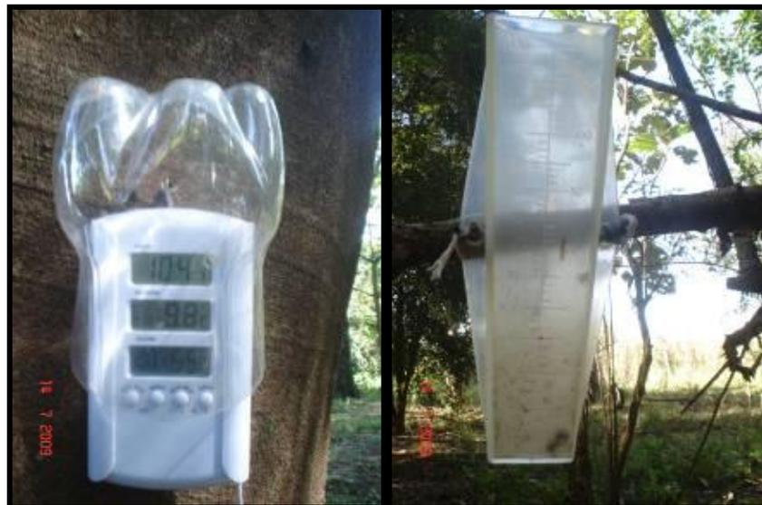
**Figura 6.** Termohigrômetro e Pluviômetro utilizados nos experimentos realizados com carcaças de suínos (abrigadas e desabrigadas - controles) expostas no arboreto, dentro do campus da Universidade Estadual de
