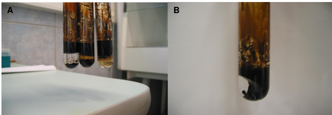
Figura 4. Teste de emulsificação utilizando petróleo. Painel A: Clone 10B e controles surfactantes sintéticos Tween 80 e Triton x100 (da esquerda para a direita), após 24 horas. Painel B: Controle positivo P. aeruginosa CBMAI 602.
