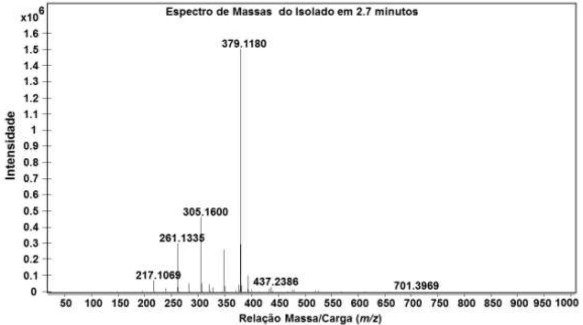
**Figura 3.33:** Espectro de massas da cubebina obtido pelo método +-ESI-MS.
