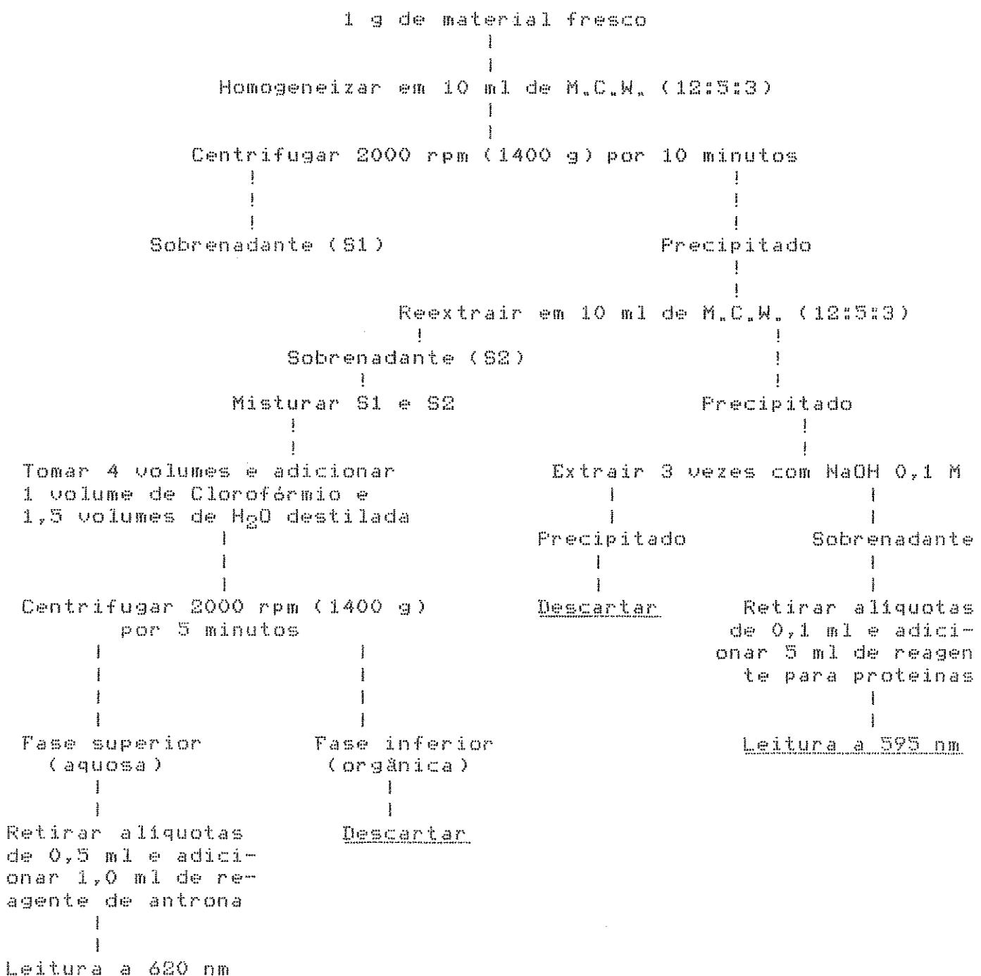
Após o aquecimento foi feita a leitura de absorbância das amostras em um espectrofotômetro MICRONAL a 620 nm.
