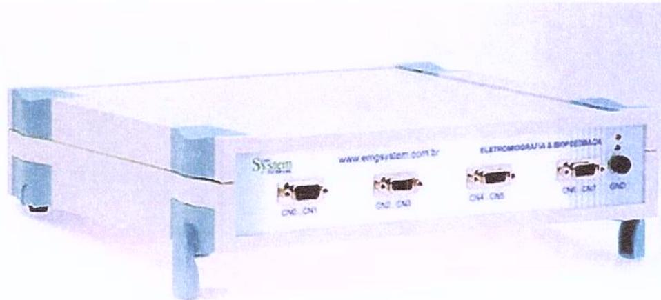
Figura 2 – Eletromiógrafo composto por 4 canais
