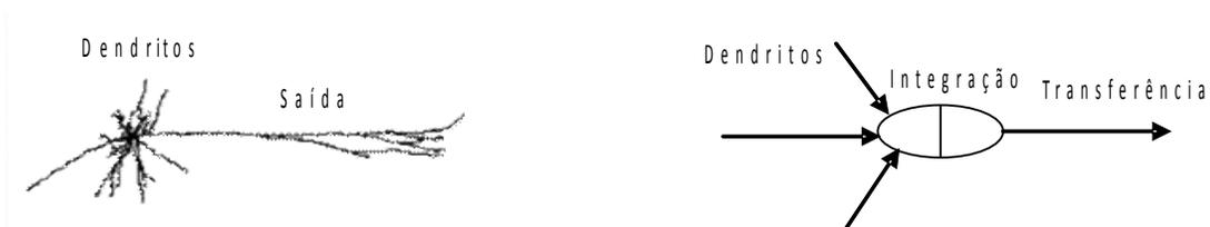
FIG 5: Esquema comparativo ilustrando um neurônio biológico e outro artificial (direita) do tipo McCulloch e Pitts.
