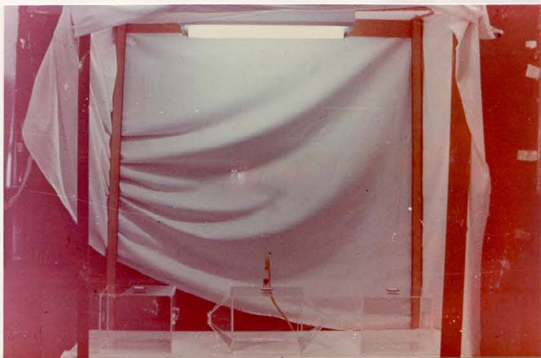
FIGURA 16 - SISTEMA DE ILUMINAÇÃO UTILIZADO NO INTERIOR DO COMPARTIMENTO
