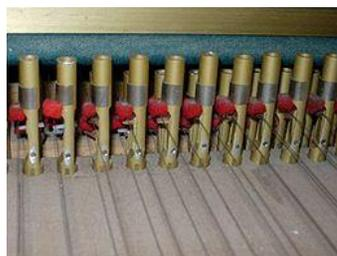
**Figura 17** - Saltarelos cilíndricos do modelo *Neupert*
