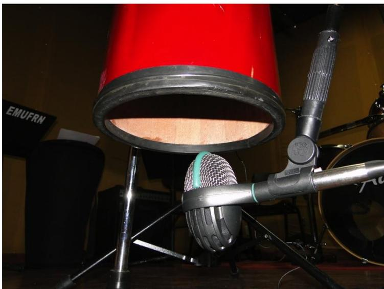
**Figura 25:** Microfone AKG D-112: Dinâmico Botton (DB), posicionado na cavidade inferior (duto de ressonância) do instrumento.
