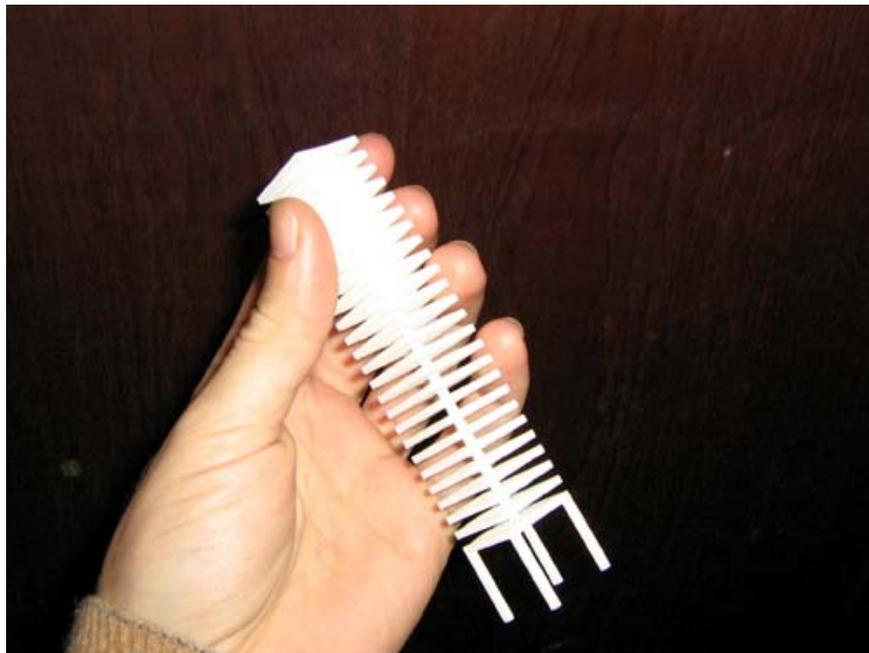
Fig. 37 – COSER, T. *Segundo protótipo*. SLS, Nylon, 2 x 2 x 12 cm, 2006.
