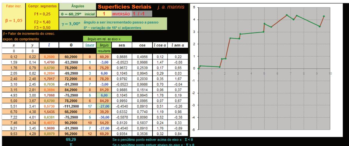
Figura 7.9 – O contraste entre o comprimento dos segmentos (que representam largura dos painéis formadores da superf) pode ser aumentado modificando os valores F1 - F2 - F3 de 0,30 - 0,88 - 0,45 para 0,25 - 1,40 - 0,50. Compensando o aumento de comprimento do conjunto, o fator de incremento  $\beta$  é diminuído para 1,05. Observa-se que a angulação dos segmentos é a mesma que na Figura 7.8, porém os elementos estão mais contrastados entre si.
