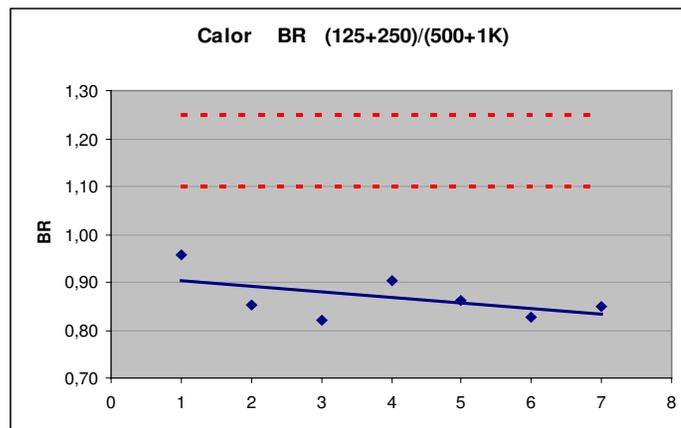
Figura 8.32 – Medições *auditório: calor (BR)* em cada um dos pontos de medição (1 a 7 no eixo horizontal). Em pontilhado valores usuais.
