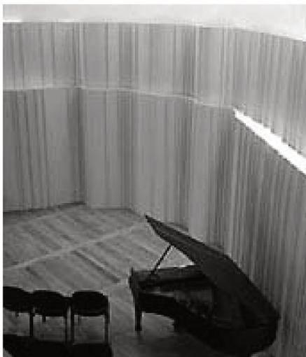
**Figura 5.11** – Difusores de curvas otimizadas (OptiCurve™) no Edwina Palmer Hall. Fonte: Cox e D’Antonio (2004, p. 54, fig. 2.30) Foto: Arup Acoustics.
