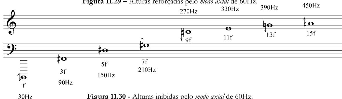
Figura 11.30 - Alturas inibidas pelo *modo axial* de 60Hz.
