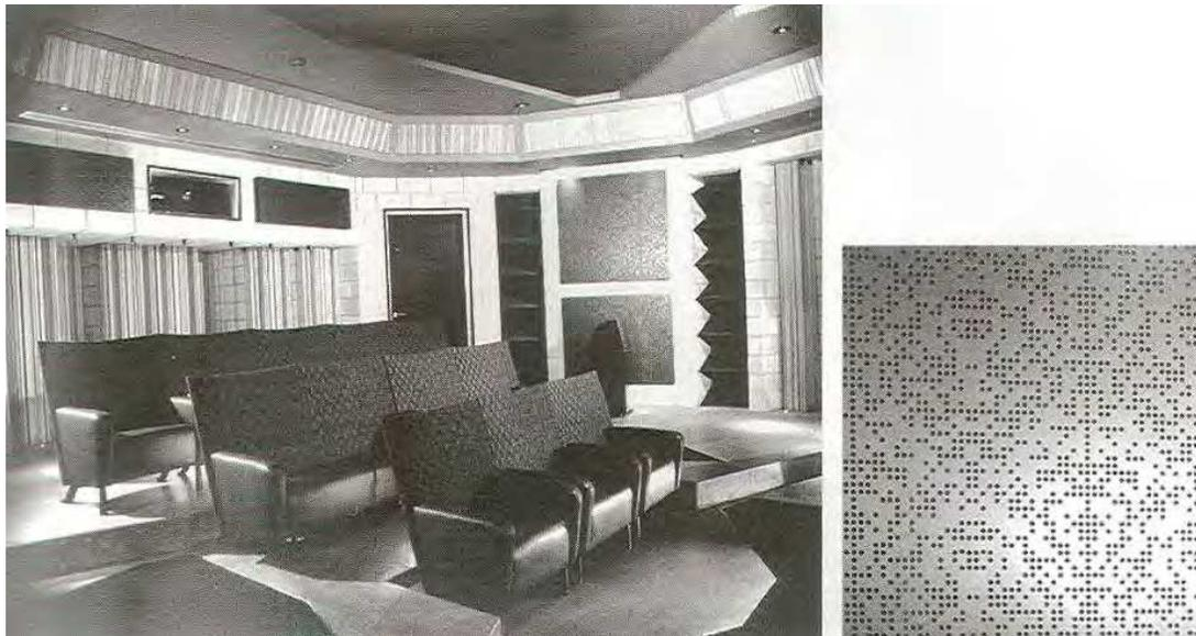
**Figura 5.6** – Superfície híbrida plana (BAD panel) em um home theater (painéis quadrados à esquerda dos ouvintes e à direita da ilustração).
