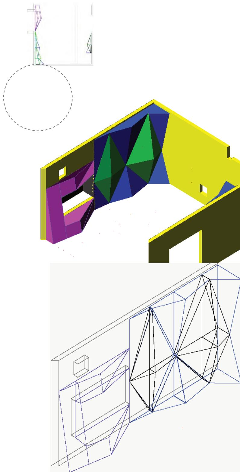
**Figura 11.13** – Conjunto formado pelas duas superfícies de madeira instaladas lado a lado sobre a parede lateral esquerda da Sala de Gravação.
