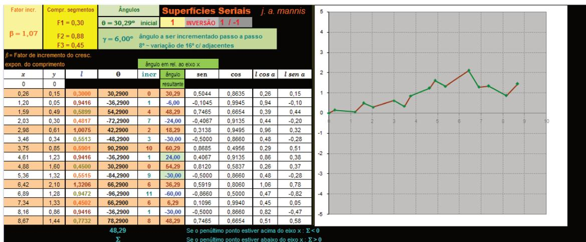
**Figura 7.3** – A partir da situação da *Figura 7.2*: Inversão (de -1 para +1) (o gráfico passou para o lado positivo do eixo das ordenadas) e alteração do ângulo de incremento  $\gamma$  de  $8^\circ$  para  $6^\circ$  (em cima à esquerda), prolongando e abrindo o todo.
