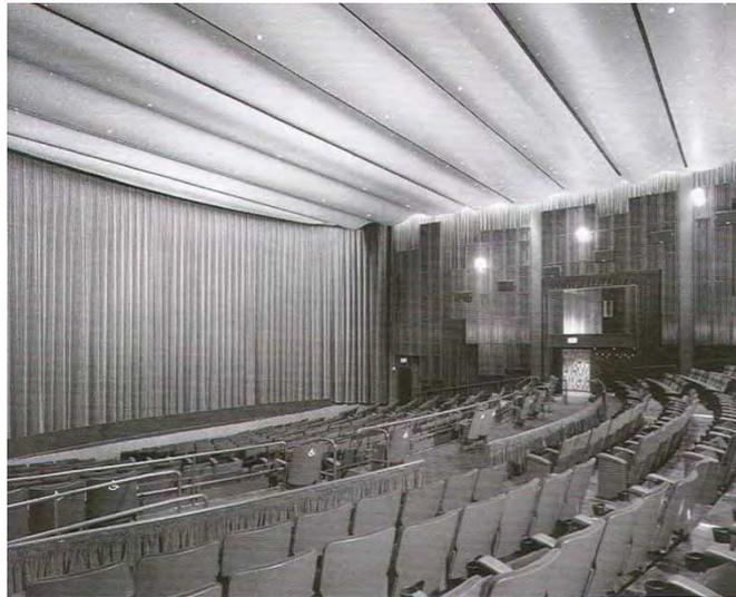
**Figura 5.8** – *Cinerama Theatre, Seattle, WA*, com difusores OptiCurve™ no teto, minimizando colorações produzidas pelas primeiras reflexões. Fonte: Cox e D’Antonio (2004, p.46, fig. 2.21) Foto: University of Salford.
