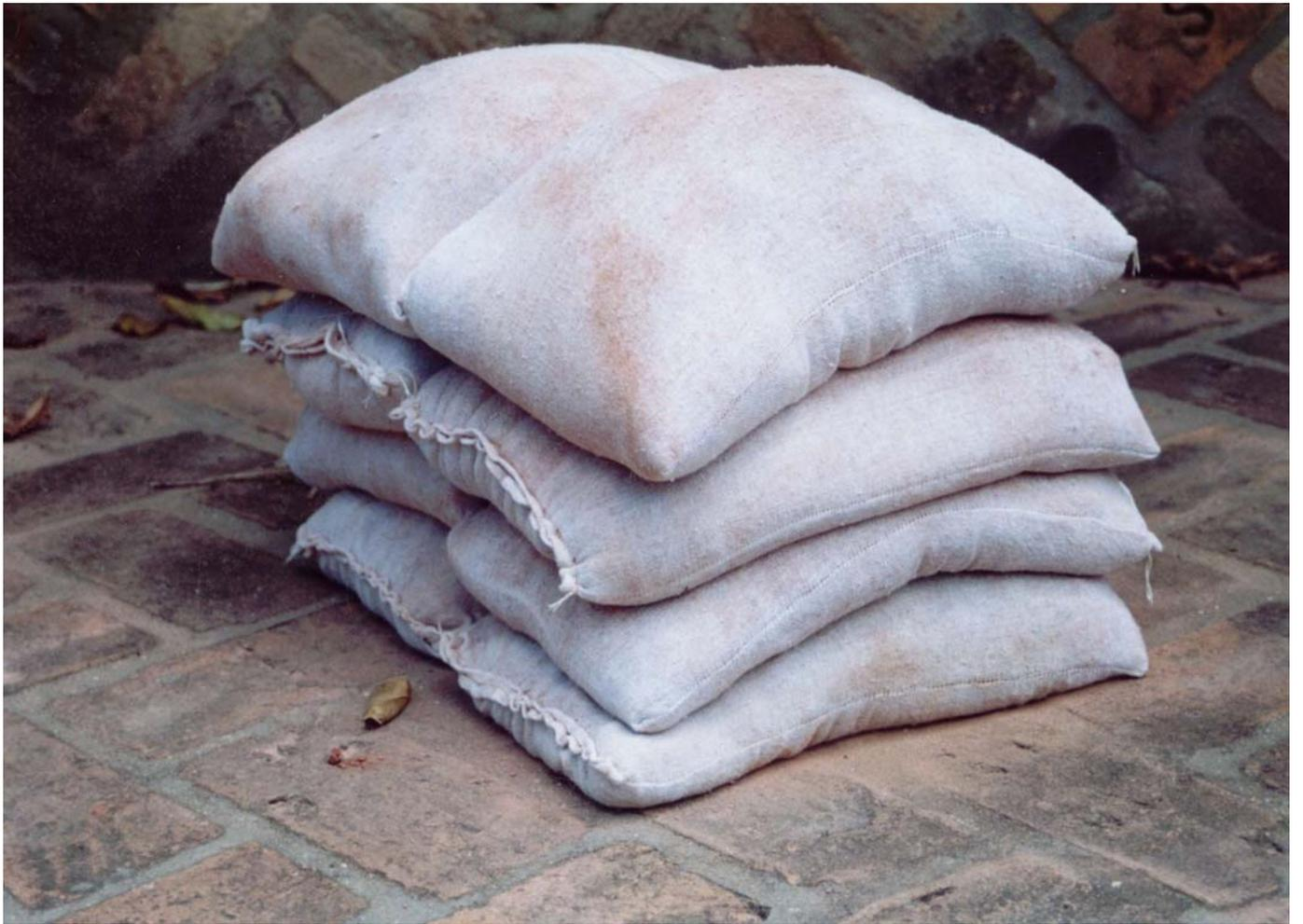
**FIGURA 38 – Protótipo de gabiões de sacos com solo para a Instalação – 0,5x0,5x0,5 m. ( foto – Ismar Curi)**
