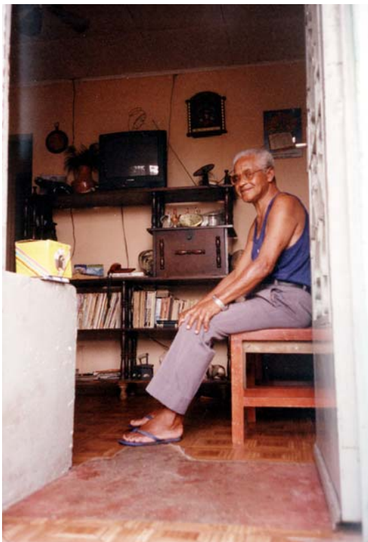
Fig. 50 - Como podemos perceber, sob o carpete de borracha imitando taco de madeira, o piso original de cimento com a adição posterior de cobertura de “vermelhão”. Esse tipo de revestimento foi muito utilizado na vila por ser barato e de fácil aplicação e manutenção. Era composto de uma mistura de pigmento vermelho marca Cardeal com cera em pasta, da marca Dominó.
