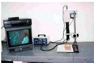
56 - Microscópio óptico onde foi monitorado o processo de corrosão das chapas de aço, 1997.
