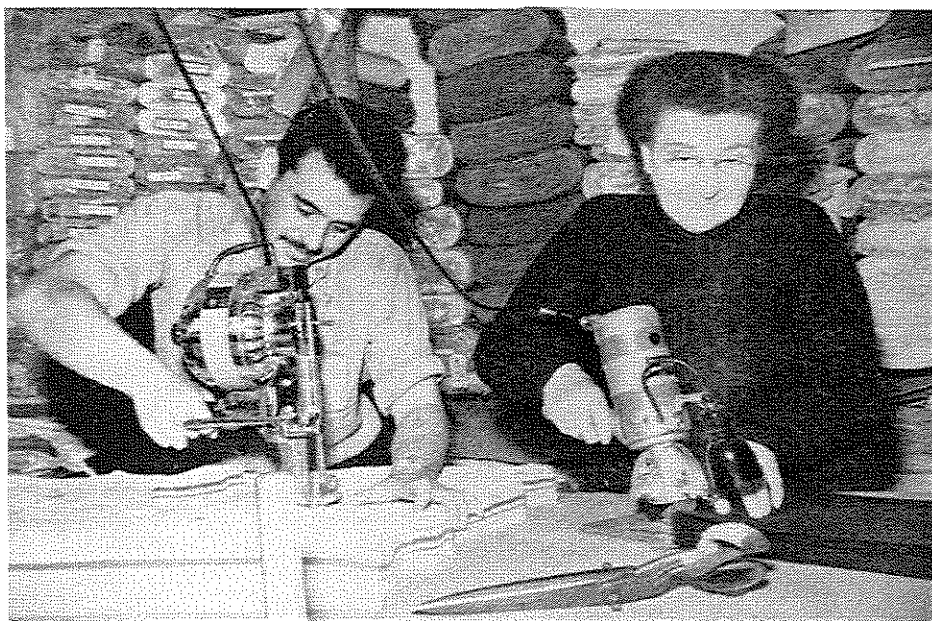
Foto 18 - Máquinas para cortar tecido com navalha reta e de disco, ambas de grande capacidade. Observar a grande quantidade de peças que estão sendo cortadas. Elas podiam ser utilizadas tanto para tecidos leves como para tecidos pesados. Atrás dos funcionários, podemos verificar a grande quantidade de tecidos que era necessário estocar para manter a produção. Foto publicada no relatório de 1955.
