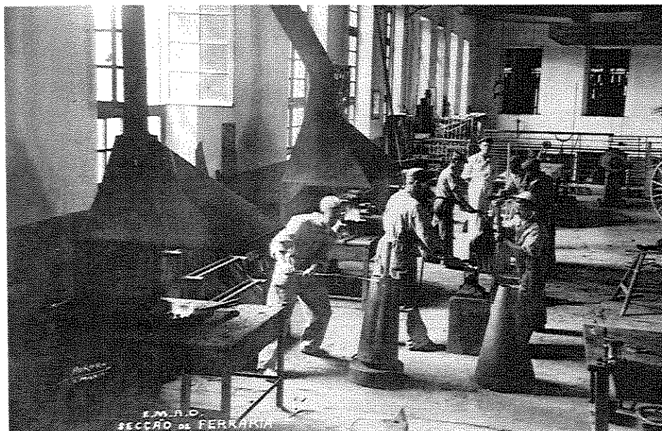
Foto 57 - Oficina de ferraria. À esquerda, as duas forjas fixas e, ao fundo, a serralharia. No centro, uma guia que era utilizada para dobrar os ferros previamente aquecidos. Foto da década de trinta: acervo da Cooperativa.
