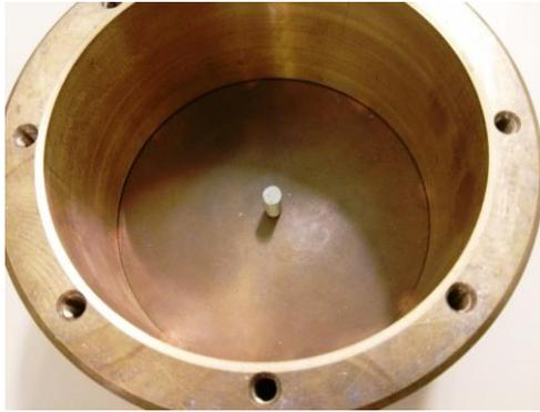
**Figura 48** - Corpo de Prova de Borracha dentro da cavidade.
