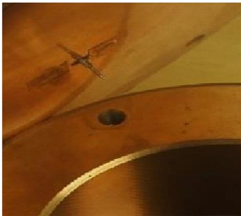
**Figura 15** - Vista interna do Segundo conector fixado na tampa superior da cavidade.
