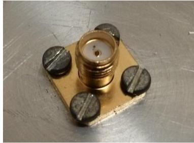
**Figura 41** - Conector SMA Fêmea com prolongação da antena.
