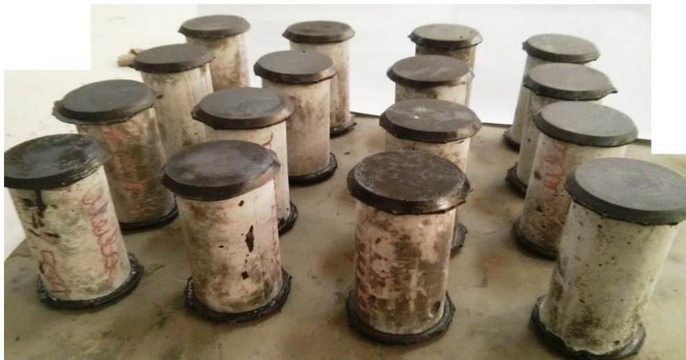
Já para a fabricação dos corpos de prova utilizados para os ensaios de radiofrequência, foram empregados moldes plástico de 6 mm de diâmetro interno e 10 mm de altura. Dos 4 corpos de prova moldados foi selecionado o de melhor acabamento superficial para ser testado (Figura 38). O corpo de prova de resíduo de borracha proveniente de pneu inservível foi fabricado através da compactação desse resíduo dentro do molde de tubo plástico, conforme ilustra a Figura 39.
