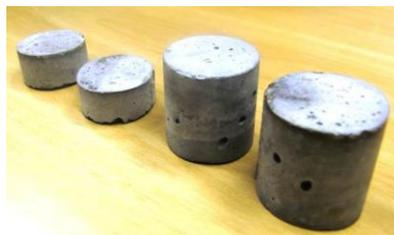
Individualmente foram ensaiados os quatro corpos de prova com o intuito de identificar se esse tamanho de corpo de prova seria adequado para os ensaios. Cada corpo de prova foi colocado de forma centralizada na cavidade conforme a Figura 23.
