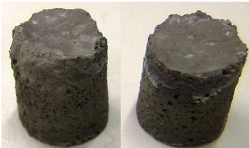
*Figura 29 - Corpos de prova provenientes do molde de plástico.*
