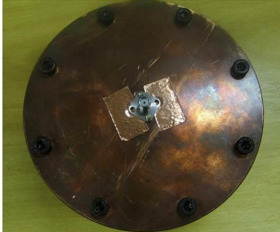
Tendo concluído a construção da cavidade (Figura 16), os ensaios foram iniciados utilizando um analisador de redes, também conhecido como *S-Parameter Test Set*, da Hewlett Packard (HP), equipamento que injeta uma frequência dentro da cavidade conforme faixa pré-determinada de atuação, analisando o sinal inserido e recebido da rede.
