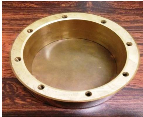
Foram realizadas simulações com a cavidade em vazio utilizando o software HFSS para prever seu comportamento. Também foram realizados ensaios experimentais com a cavidade em vazio para compará-los com a simulação.
