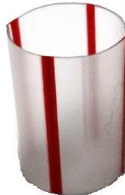
*Figura 28 - Corpos de prova provenientes do molde de alumínio.*
