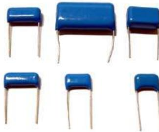
Fig 19 - Capacitores de poliéster
