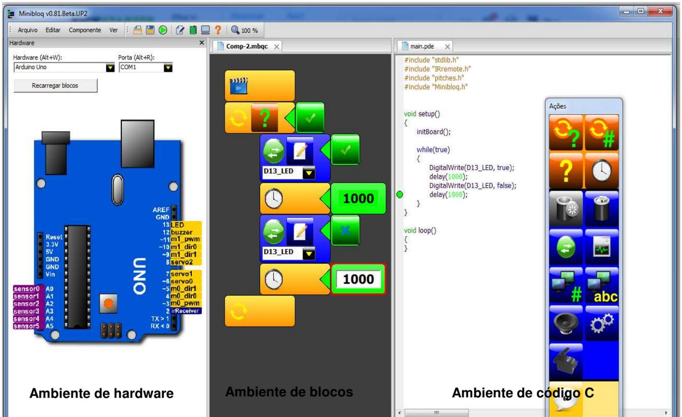
Figura 16: Captura de tela do Software Minibloq, onde podemos conferir da esquerda para a direita, a imagem da placa Arduino Uno, no meio o ambiente de programação em blocos, o código de programação em C++ e uma janela flutuante contendo as ações de programação do Minibloq.
