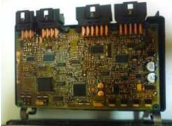
Figura 11: Foto de um modelo injeção eletrônica automotiva que possui microcontroladores.
