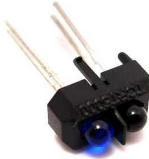
Fig 29 – Sensor óptico TCRT-5000
