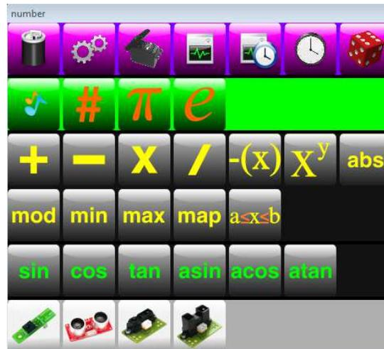
Figura 19 – Menu de configuração do bloco temporizador, onde podemos escolher e configurar conforme a necessidade do projeto e do programa.
