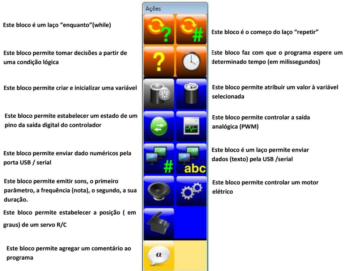
Figura 17: Captura de tela do bloco de ações para a programação para o Arduino
