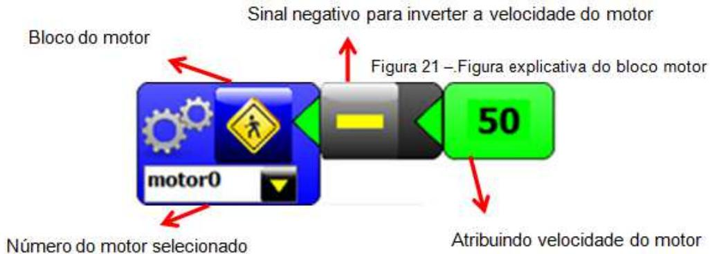
Fig 37 – Figura explicativa do bloco do motor
