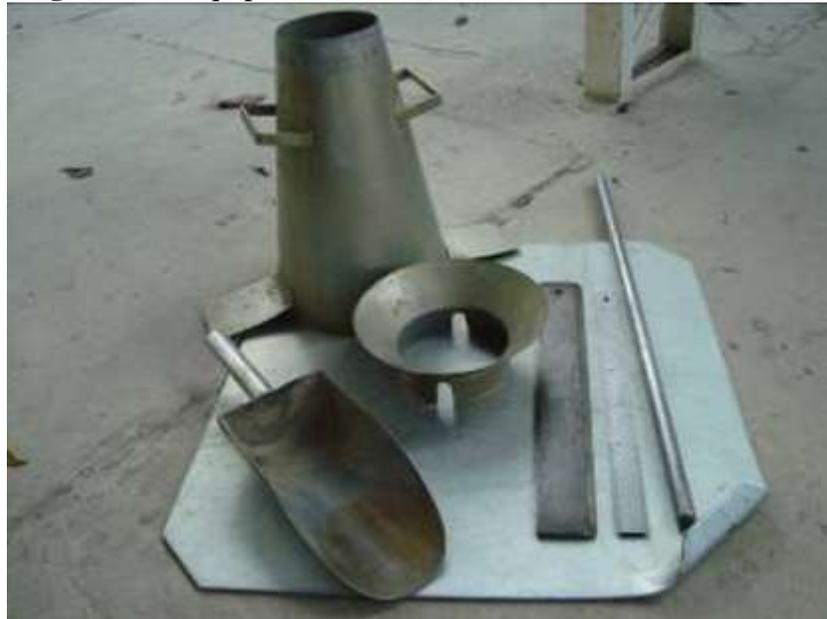
**Figura 27** – Ensaio de abatimento pelo tronco de cone.
