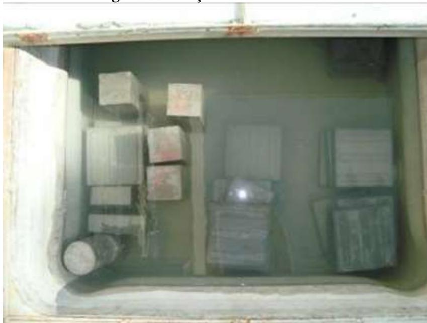
Após serem retirados da câmara úmida 24 horas antes do rompimento, os pisos tiveram suas larguras cortadas em 140 mm, com serra de disco conforme Figura 34, pois de acordo com a ABNT NBR 9781:2013, para o ensaio de resistência à compressão a largura da peça não pode exceder a esse limite.
