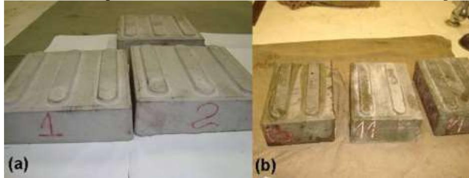
Em seguida, os pisos tiveram sua face inferior e superior capeadas com uma mistura de 75% de enxofre e 25% de caulim com a finalidade de regularização das superfícies de carregamento. Após o capeamento, os pisos foram conservados em câmara úmida até o momento do rompimento. Na Figura 35 observa-se o processo de capeamento dos pisos.
