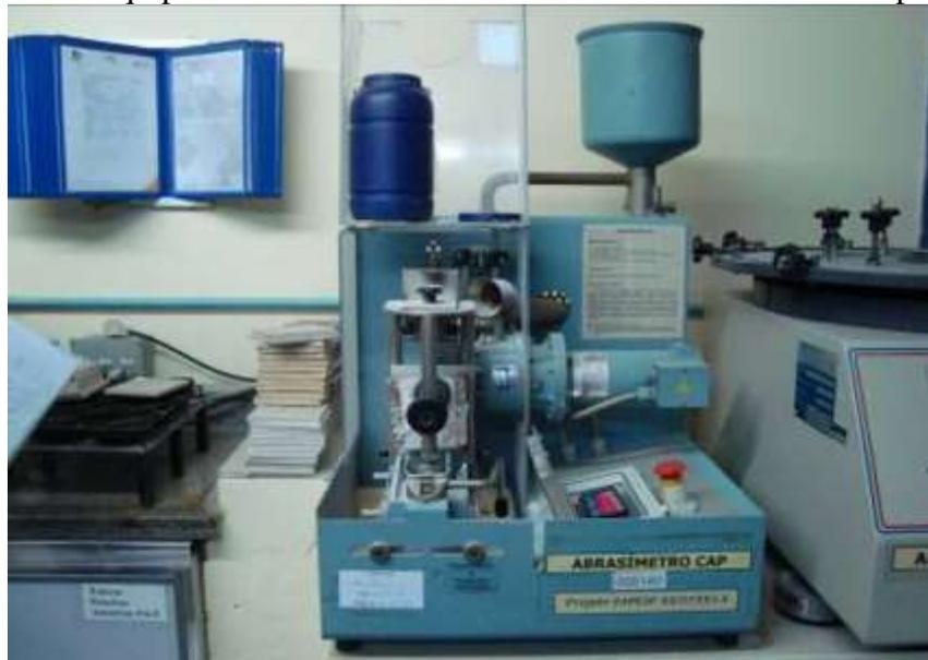
Antes do ensaio, as placas foram lavadas com água corrente e enxugadas com um pano úmido. No ensaio, a placa é colocada no equipamento de maneira que tangencie em relação ao disco rotativo. O disco de aço utilizado possui diâmetro de 200,20 mm e espessura de 10 mm. Na
