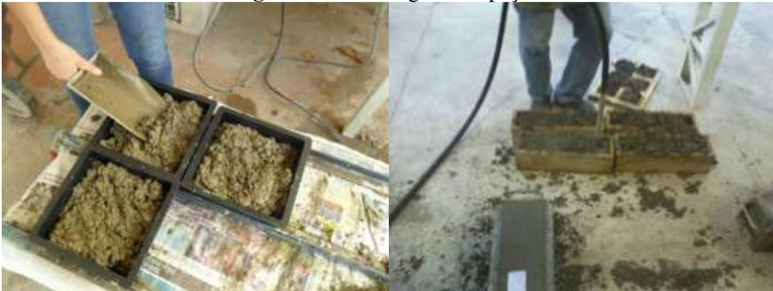
Em seguida, os pisos, os corpos-de-prova prismáticos e as placas, moldadas, foram acondicionadas em câmara úmida e decorrido um período de 24 horas, foram retiradas dos moldes e identificadas. A moldagem e cura obedeceram a ABNT NBR 5738:2008. Na Figura 30 observam-se os pisos moldados acondicionados na câmara úmida e na Figura 31 os pisos, e corpos-de-prova retiradas dos moldes e identificadas.
