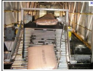
**Figura 5 – Modelo de Sistema de Movimentação Automática de Sacaria**
