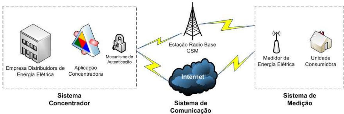
Figura 3-1: Diagrama de blocos do sistema a ser desenvolvido. Fonte: Autor
