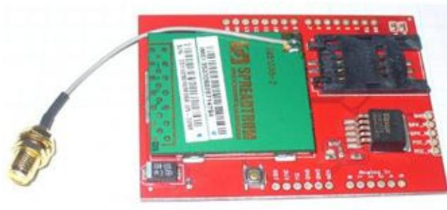
Figura 4-8: Placa Shield Cellular com módulo SM5100B. Fonte [55]
