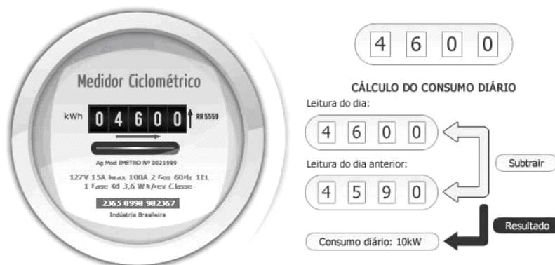
Figura 2-4: Medidor ciclométrico. Fonte [34]
