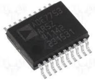
Figura 4-1: Circuito Integrado ADE7753. Fonte [51]
