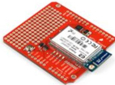
Figura 4-9: Placa WiFly Wi-Fi Shield. Fonte [56]
