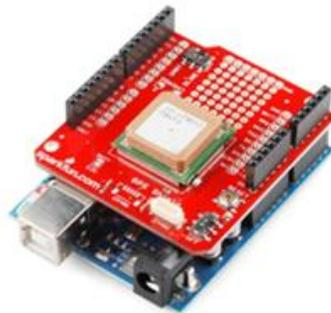
Figura 4-10: Placa GPS Shield. Fonte [57]
