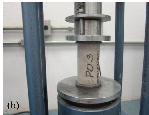
Após este período, os corpos-de-prova foram resfriados à temperatura ambiente, capeados e submetidos aos ensaios de resistência à compressão axial para a determinação da atividade pozolânica. De acordo com a norma NBR 12653/2012 as misturas avaliadas devem apresentar resistência igual ou superior a 75% da argamassa controle sem resíduo (ABNT, 2012c).
