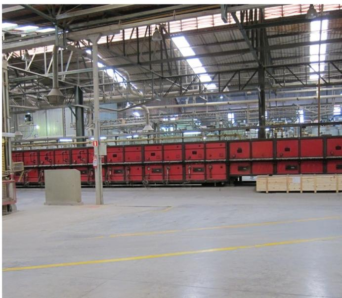
Finalizado o processo de queima, os corpos cerâmicos passam por uma etapa de resfriamento rápido até atingir a temperatura de 650 °C para em seguida entrarem em um ciclo de resfriamento lento devido à evolução do quartzo aproximadamente a 570°C (MALISKA, 2007).
