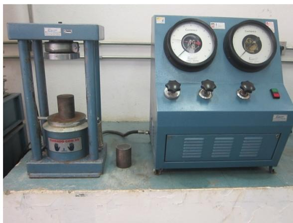
No ensaio de resistência à compressão, os pisos pré-moldados de concreto foram colocados na prensa e alinhados de tal modo que, o seu centro de gravidade coincidissem com o alinhamento do centro de carga dos cilindros de aço superior e inferior, ambos com diâmetro de  $90 \pm 0,5\text{mm}$ , sendo
