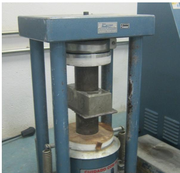
Todos os resultados dos ensaios de resistência a compressão axial foram aferidos em Newton (N) e transformados em MPa, ou seja, obtém-se a carga de ruptura do concreto (N), a qual dividida pela área de aplicação da carga e multiplicando-se por 0,95 (fator multiplicativo constante na Tabela 3) resultando na resistência (MPa), de acordo com a equação a seguir :
