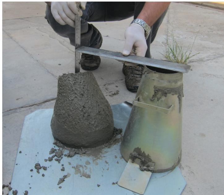
A principal função do ensaio de abatimento é controlar a uniformidade da produção do concreto, sendo que a ocorrência de uma variação fora do normal no resultado do abatimento pode significar uma mudança imprevista nas proporções da mistura, na granulometria ou no teor de água no concreto.
