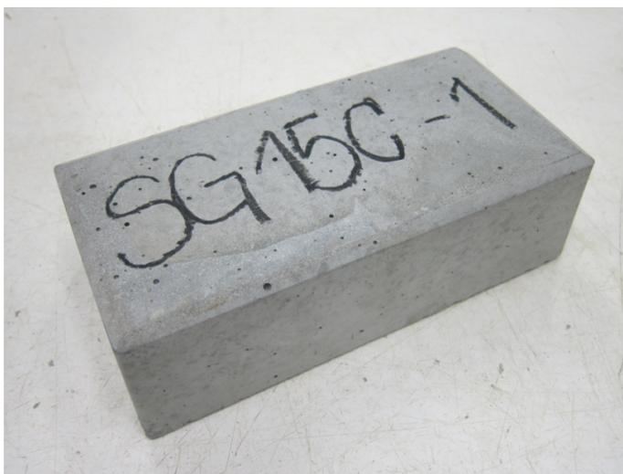
Para cada traço de concreto foram produzidos um total de 16 (dezesesseis) pisos, sendo 14 (quatorze) pisos para rompimentos nas idades de 7 e 28 dias para os ensaios de resistência à compressão axial e dois pisos para os ensaios de absorção de água e porosidade aos 28 dias.
