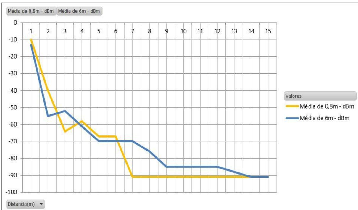
Figura 5.5.1 – Comparativo da variação do Sinal RSSI (dBm) em relação às distância (m) dos *motes* com sorvedouro posicionado nas alturas 0,8m e 6m.
