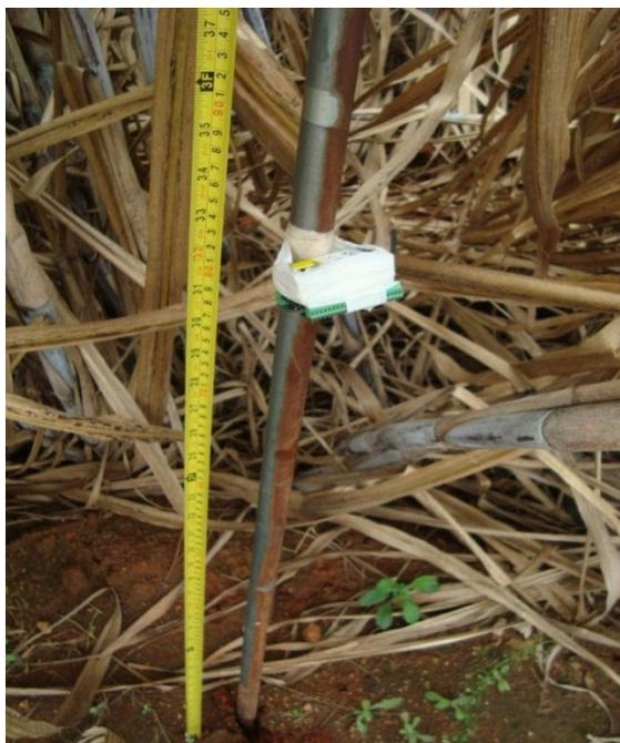
Figura 5.3 – *Mote* IRIS dotado de placa de sensoriamento posicionando com altura 0,8m aplicado em plantação de Cana-de-Açúcar FAZENDA ITAIQUARA, 2011.
