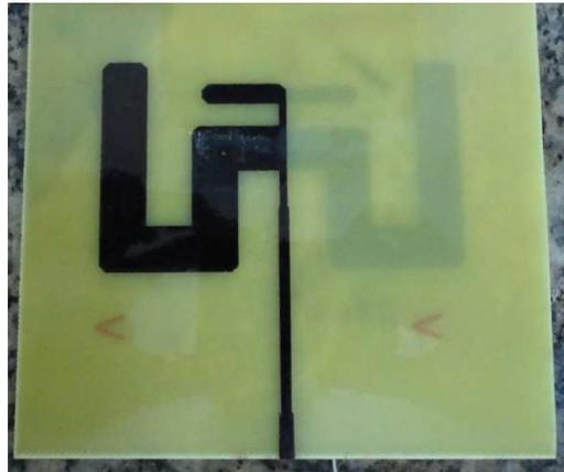
Figura 3.7: Final do processo de corrosão.
