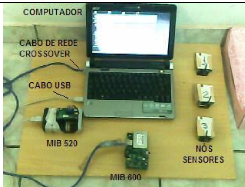
Figura A.5.1 – Estação de base composta por duas placas de aquisição de dados executando funções de monitoramento e análise de tráfego de rede e três nós sensores.
