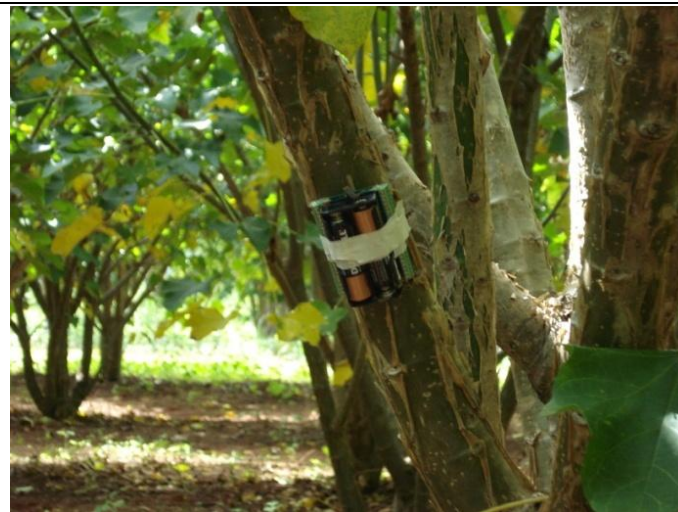
Figura 3.2.4.9 - Nó sensor XM2110 com placa MDA300 instalado no campo de pinhão a uma altura de 0,80m do solo.
