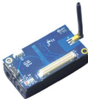
Figura A.1.1 - Mote XM2110 com antena padrão – Fonte: MPR/MIB User's Manual (2007).
